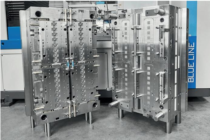
**Komplexe Aufgabe, clever gelöst:** 32-fach-Heißkanalwerkzeug zur Herstellung der TPE-Muffen einer Aufputzdose beim Werkzeug- und Formenbauer SchoForm © SchoForm
