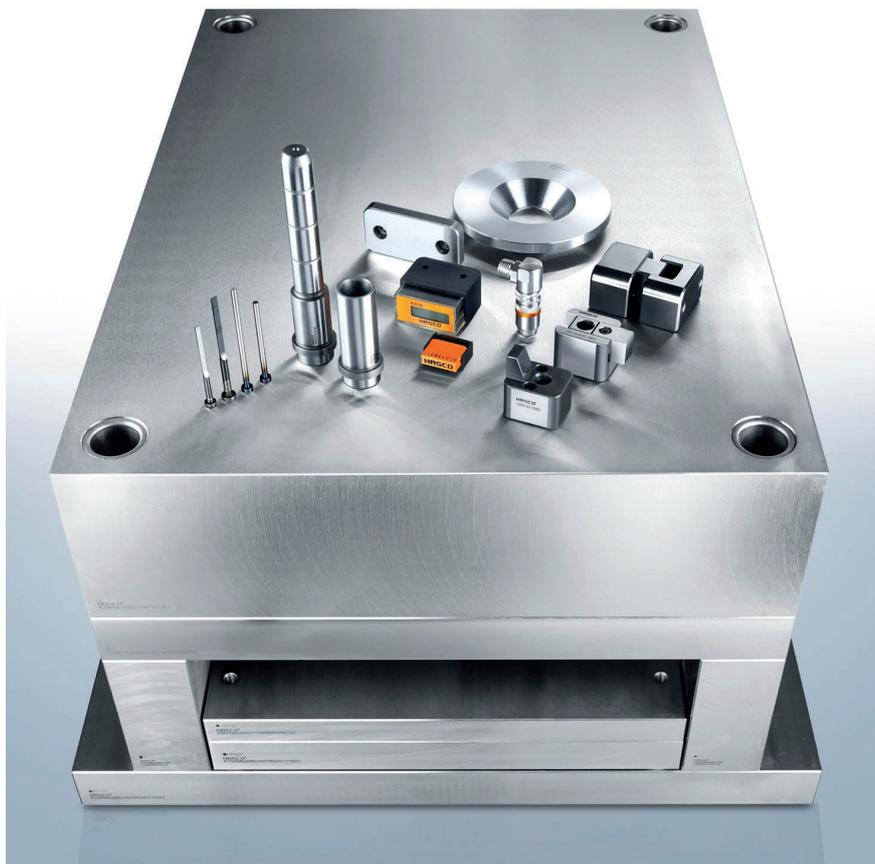
**Basis für eine hoch effiziente Werkzeugfertigung:** Standardisierter Formaufbau mit Zubehörteilen © Hasco
